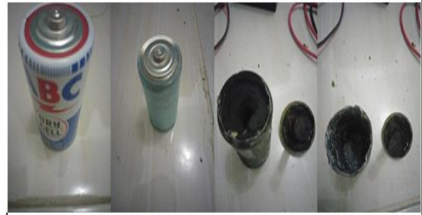
Gambar 8. Awal Mula Baterai Tipe A1 Dan Proses Pengosongan Pada Pasta Batu Baterainya
