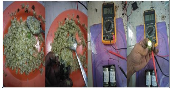
Gambar 12. Baterai Yang Sudah Terisi Dengan Kulit Buah Jeruk Nipis Yang Sudah Di Haluskan Beserta Nilai Tegangan Dan Arus Yang Telah Diperoleh
