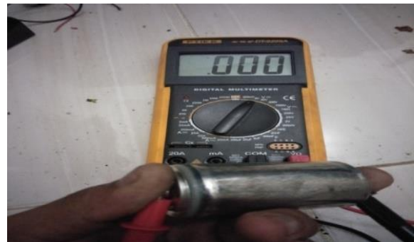
Gambar 10. Baterai Pada Saat Tegangan 0 Volt
