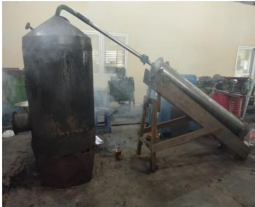
Gambar 1. Proses Pirolisis (Pembakaran)
