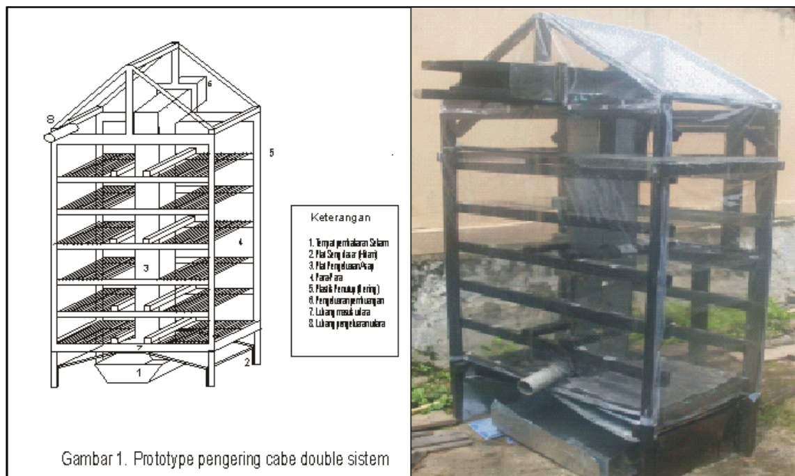
Gambar 1. Hasil Rancangan Alat Pengering.
