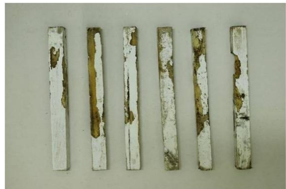
Gambar 2. Kerusakan sampel kayu setelah uji kubur
