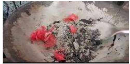
Gambar 2. Campuran Aspal tebu dan Plastik
